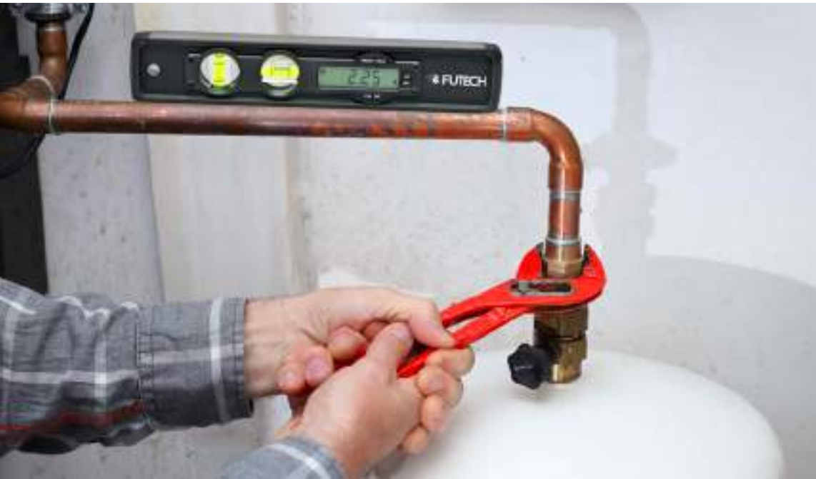
Μετρήστε τη γωνία κλίσης σας σε πολλαπλές μονάδες (μοίρες °, mm/m, %, in/ft).
